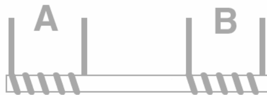
Gambar 2 Bentuk sederhana sensor magnetik fluxgate.
